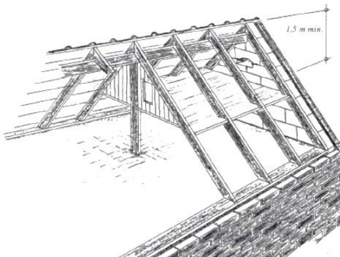
Figure 8. Schéma de l'aménagement d'un surcomble destiné aux chauves-souris par cloisonnement du comble existant (illustration tirée de Fairon et al. 1996).
